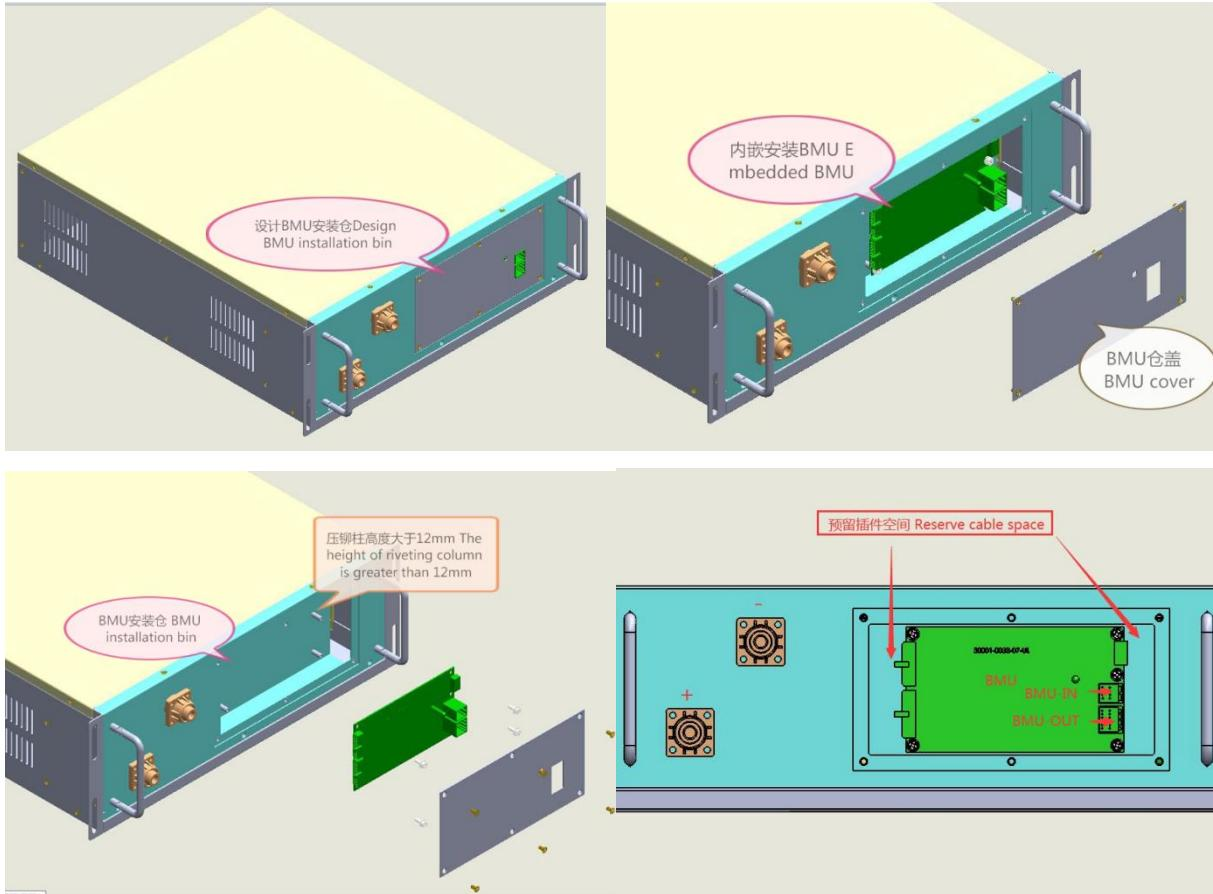
4.1.2 如果不方便设计内嵌 BMU 安装仓，可选配 BMU 金属盒，外形尺寸见下图一。安装在电池箱外部，安装方式参考下图二。
